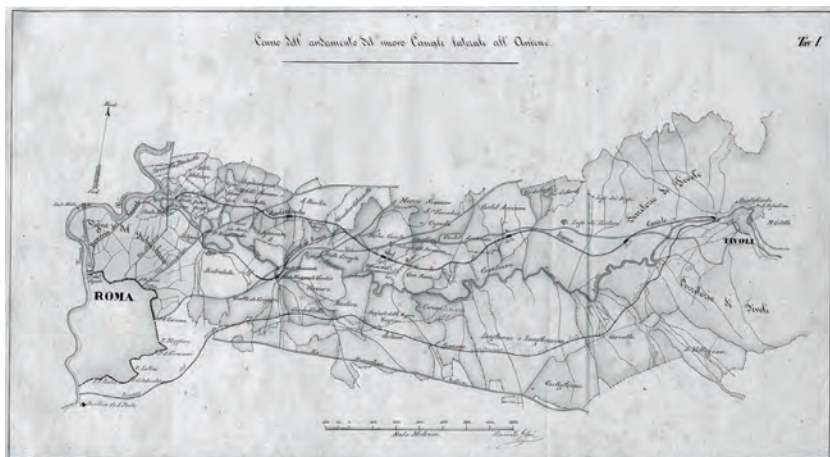
Fig. 4 – Progetto di un canale laterale al corso dell'Aniene, con le sue derivazioni utilizzate per la navigazione interna, l'irrigazione e la costruzione di nuove fabbriche, V. Glori, Roma 1869.
